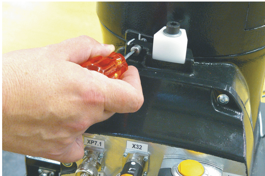
Fig. 5-21: Retirer le capuchon de protection de la cartouche de mesure
