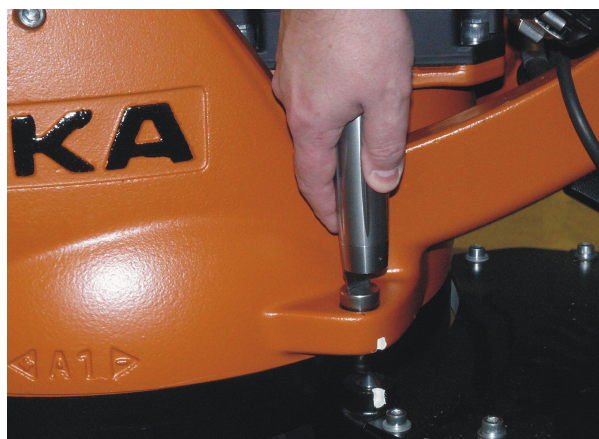
Fig. 5-13: Retirer le capuchon de protection de la cartouche de mesure
